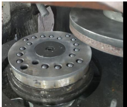
Рис. 1. Вид на робочу зону верстату – сепаратор з кулями, нижній диск та шліфувальний круг
