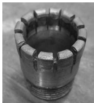
Рис. 19 – Вузол для електроспінання та спечена коронка діаметром 76 мм
