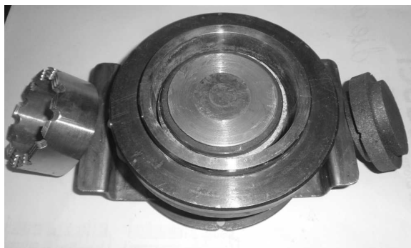
Рис. 19 – Вузол для електроспінання та спечена коронка діаметром 76 мм
