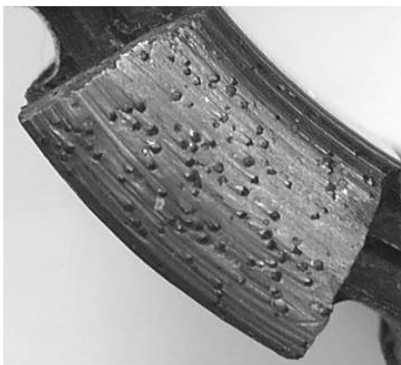
Рис. 20 – Робоча поверхня електроспеченої коронки Ø 76 мм після випробувань
